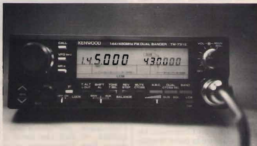
foto 1 Il Kenwood TM-731E VHF/UHF. Notare i punti dopo ognuna delle prime 3 cifre delle frequenze Main e Sub: indicano che è stata attivata la funzione "Transponder".
